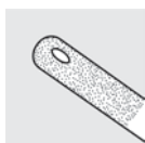
G-22100 SAUGHANDGRIFF n. D.D. KOCH - T. KOHNEN Saugöffnung 0.3 mm, Spitze aufgerauht, Rohr 22 Gauge / 0.7 mm
